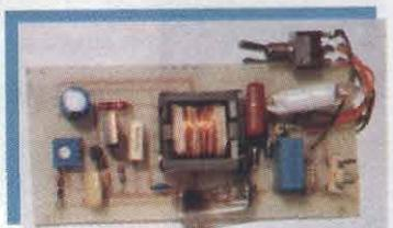
Un simpatico circuito corre in aiuto degli appassionati di radio antiche ed apparati valvolari in genere per la verifica degli isolamenti.
