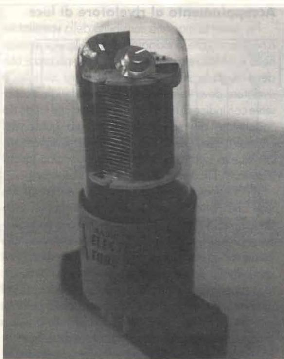
Foto 4 - La "gloriosa" 931A, un fotomoltiplicatore molto diffuso che ogni tanto si può trovare in fiera per poche migliaia di lire. In questo tubo il fotocatodo è costituito da un filo steso a griglia all'interno del tubo, ed i dinodi sono disposti circolarmente in modo da costringere gli elettroni su una traiettoria "a spirale". Purtroppo la scarsa sensibilità di questi tubi non li rende adatti ad essere impiegati per rivelatori a scintillazione.
