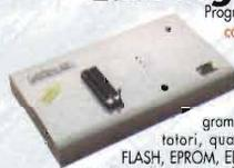
Programmatore universale, di basso costo, con possibilità di Test per RAM, TTL, CMOS, ecc. Programmazione ad alta velocità. Ha uno zoccolo da 48 piedini con cui è possibile programmare virtualmente, senza adattatori, qualsiasi dispositivo in DIP tipo FLASH, EPROM, EEPROM, PIC,  $\mu P$  vari, GAL, ecc. Si collega alla porta parallela del PC.
