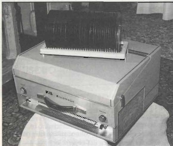
Foto 1 - Il discomatic al quale è stata tolta la rastrelliera dei dischi e volutamente appoggiata sopra onde poterne vedere la sua forma e semplicità.
