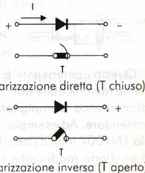
La *ddp* minima (una sorta di "forza" per chiudere e mantenere chiuso il tasto T) da applicare ai capi del diodo per poter fare scorrere una corrente è chiamata tensione di soglia e vale circa 0,2V per i diodi al Germanio e circa 0,7V per quelli al Silicio.
