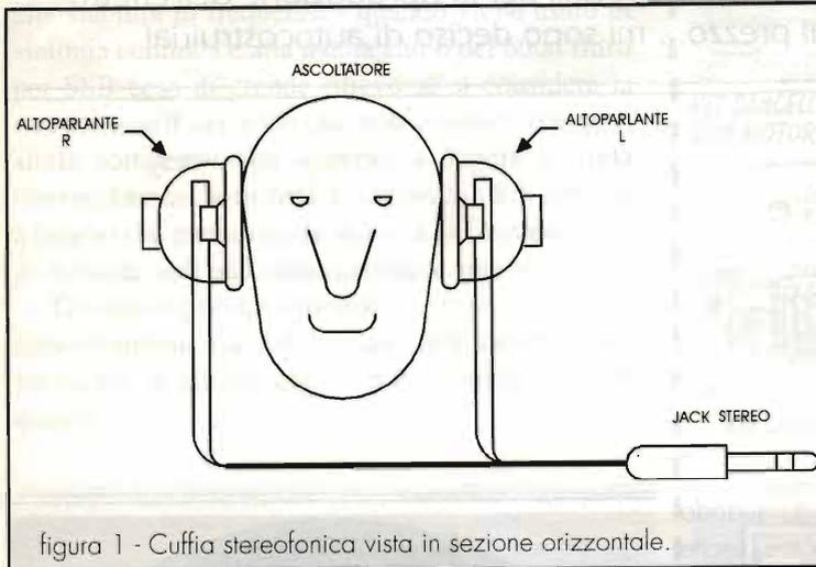
figura 1 - Cuffia stereofonica vista in sezione orizzontale.
